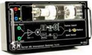
ماژول سرو و موتور یک نمونه پلنت واقعی برای اعمال تغییرات ضرائب PID است که کاربر با استفاده از کنترل کننده‌های مختلف می‌تواند سرعت و موقعیت این موتور
