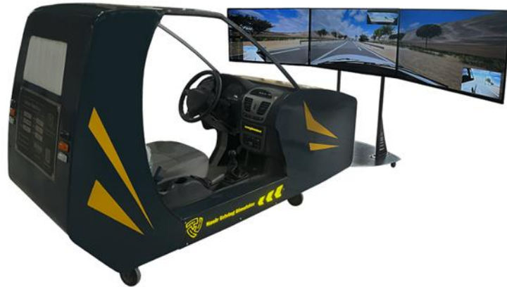
شکل ۹- نمونه دستگاه شبیه‌ساز رانندگی خودرو سبک با کابین طراحی شده‌ی معادل یک چهارم بدنه خودرو
