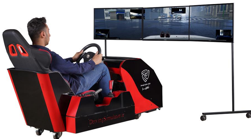
شکل ۸- نمونه دستگاه شبیه‌ساز رانندگی با کابین اقتصادی
