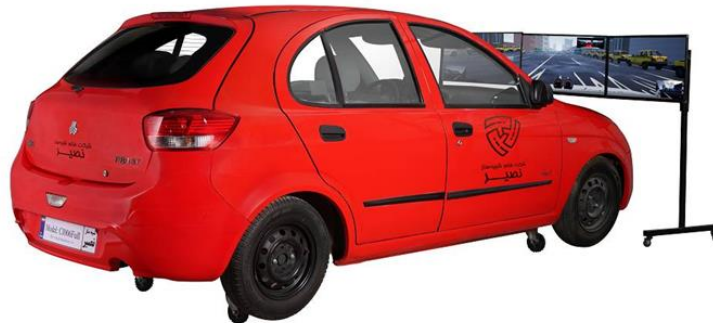
شکل ۹- نمونه دستگاه شبیه‌ساز رانندگی خودرو سبک با کابین طراحی شده‌ی معادل یک چهارم بدنه خودرو
