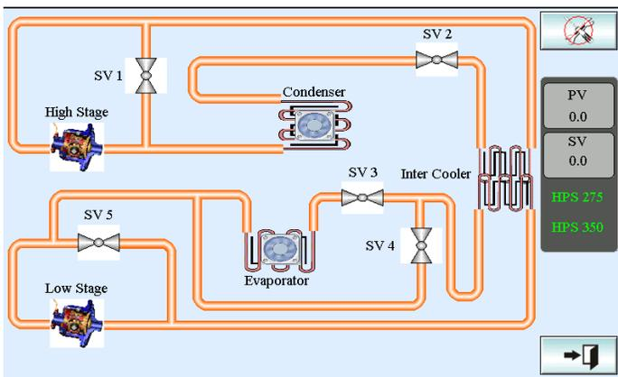
سیستم کنترل این مجموعه توسط PLC های سری 200 با برند کوتراست ، دقیقاً معادل PLC S 200 Siemens بوده و مجهز به تاج پنل 7 اینچ تمام رنگی با برند سرمیت می باشد .
