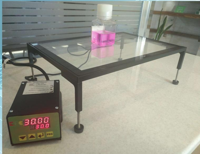
این دستگاه از دوبخش اصلی صفحه شیشه ای و کنترل کننده تشکیل شده است، بسته به نوع صفحه شیشه ای این دستگاه بمنظور کاربردهای مختلف و در قیمت های متفاوت عرضه شده است. این دستگاه برای تنظیم دمای مواد و نمونه های داخل ظروف یا زیر میکروسکوپ در آزمایشگاهها بکار
