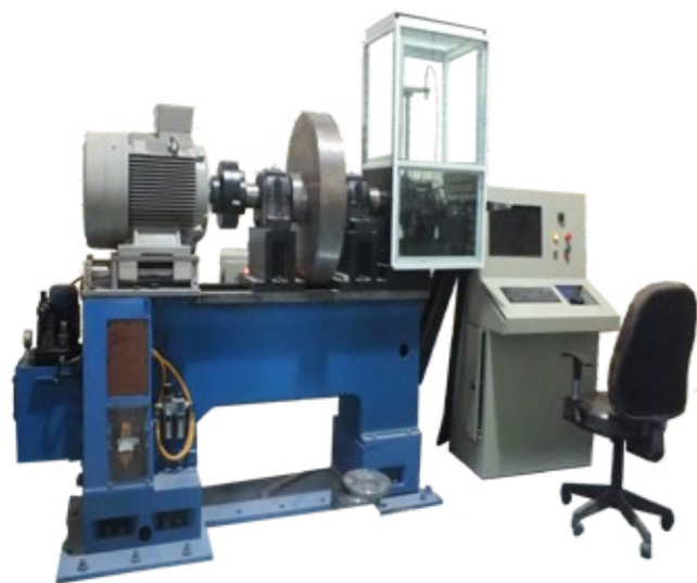
دستگاه تست عملکرد ترمز خودرو و اندازه‌گیری پارامترهای لنت ترمز از قبیل: نویز
