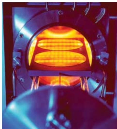
ویژه روی زیرپایه مناسب تهییه شود. جوانه زنی در فاز گاز و کنترل رشد ذرات از مهم ترین فاکتورهای فرآیند رشد است. توزیع اندازه ذرات توسط تعداد جوانه های تشکیل شده در راکتور و غلظت تراکم مواد، کنترل می شود.
