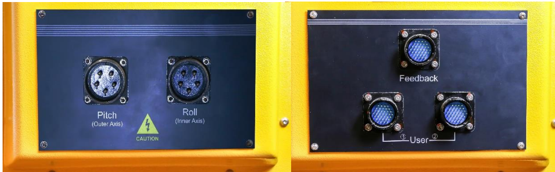
شکل 2-3 جزئیات محل اتصال کابل‌های پاور موتور و انکودر و کانکتورهای تحت تست به میز
