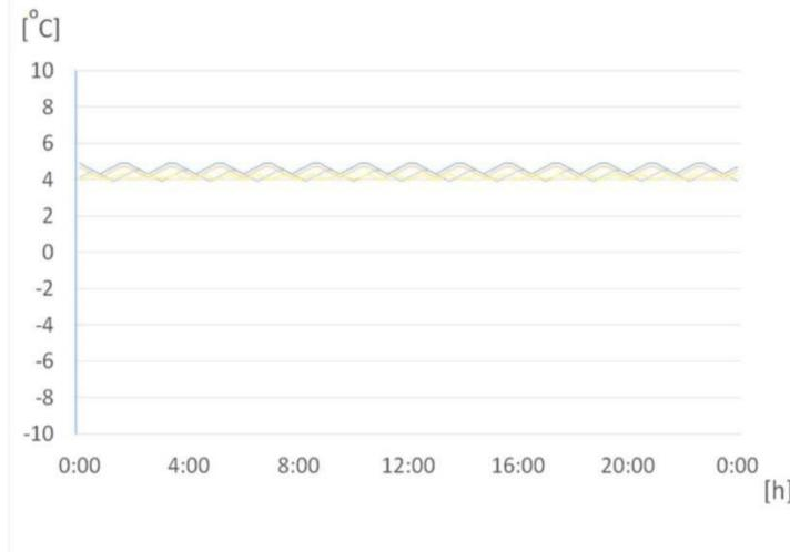
با استفاده از اوپراتور یکپارچه و سیستم Multi Air Flow مقدار ریزش برودت و الگوی گردش هوا در تمامی طبقات تقریباً برابر می‌باشد. این عوامل در کنار استفاده از سه عدد فن سرعت بالا برای به گردش در آوردن هوا و همچنین برخورداری از کنترلر دمایی دقیق تضمین کننده دمایی با اختلاف کم بین طبقات است.
