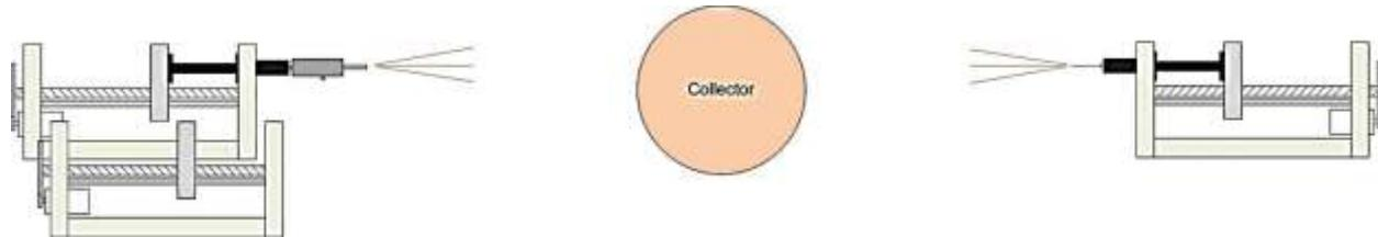
و در نهایت با بکار گیری سه سیستم تزریق مستقل امکان الکتروریسی دو طرفه از طریق سه محلول ریسنده‌گی به صورت نانوالیاف معمولی و یا نانوالیاف دو جزئی فرآهم می‌شود. برای موارد سفارشی امکان اضافه نمودن چندین سیستم تزریق مستقل در این دستگاه وجود دارد.
