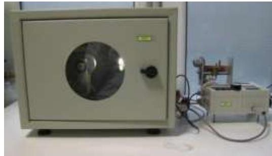
دستگاه الکتروریسی **mini- electrospinning** یک دستگاه الکتروریسی تک نازله پرتابل است که مناسب برای تولید انواع نانو الیاف پلیمری، نانوالیاف سرامیکی و ... است. این دستگاه کلیه پارامترهای مهم الکتروریسی را فراهم می کند.
