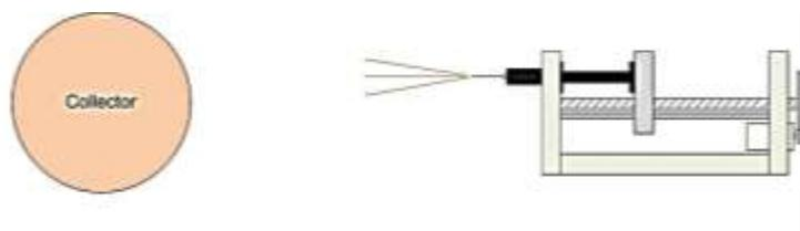
در صورتیکه از سمت دیگر دستگاه می توان دو سیال را برای تولید نانوالیاف دو جزئی، هالو نانوالیاف و ... الکتروریسی کرد. در این حالت نیز تمامی پارامترهای الکتروریسی قابل کنترل هستند.
