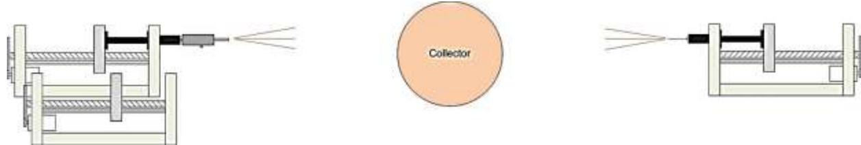
و در حالت دیگر با بکار گیری سه سیستم تزریق مستقل امکان الکتروریسی دو طرفه از طریق سه محلول ریسنندگی به صورت نانوالیاف معمولی و یا نانوالیاف دو جزئی فرآهم می شود. برای موارد سفارشی امکان اضافه نمودن چندین سیستم تزریق مستقل در این دستگاه وجود دارد.
