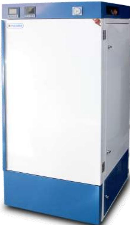
بدنه : بدنه خارجی از ورق روغنی با رنگ الکتروستاتیک و بدنه داخلی از جنس استیل ۳۰۴
