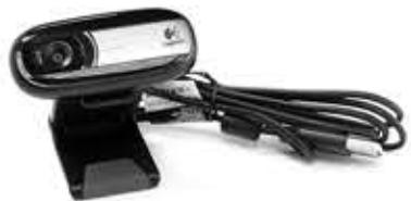
بطور پیش فرض یک عدد دوربین VGA از شرکت لاجیتك بر روی این سیستم آموزشی قرار داده شده است که با توجه به استفاده از درگاه استاندارد USB برای ارتباط مابین دوربین و بورد پردازنده، کاربر می‌تواند از ویکم‌های با کیفیت
