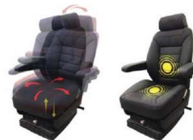
پیاده‌سازی سیستم حرکتی دو درجه آزادی برای صندلی اپراتور و لرزشگر صندلی به صورت بومی
