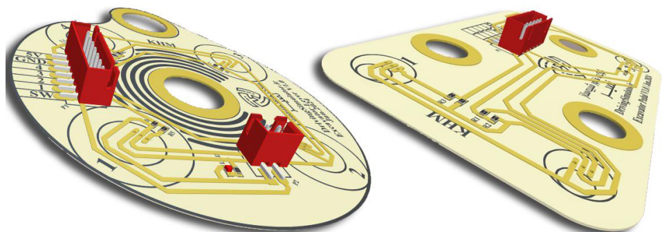
شکل ۱۴- طراحی برد الکترونیکی پدال‌های حرکتی
