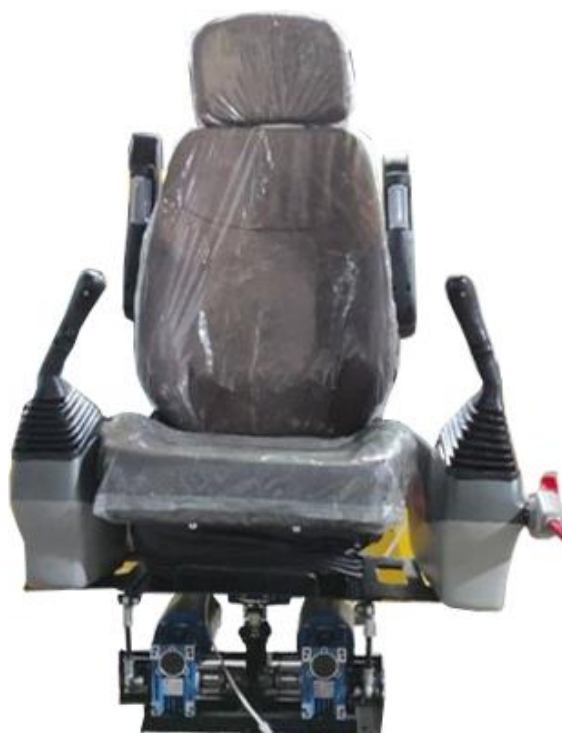
شکل ۲۳- پیاده‌سازی سیستم حرکتی دو درجه آزادی برای صندلی اپراتور به صورت بومی (ساخت ایران - شرکت فناوری شبیه‌ساز نصیر)
