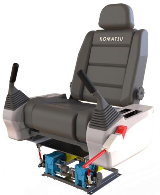
شکل ۲۲- پیاده‌سازی سیستم حرکتی دو درجه آزادی برای صندلی اپراتور به صورت بومی (ساخت ایران - شرکت فناوری شبیه‌ساز نصیر)
