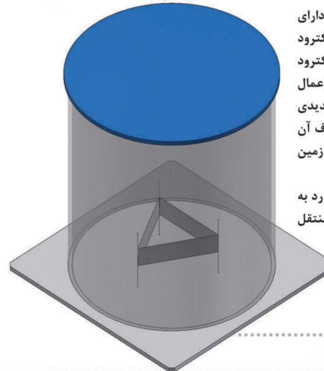
این سامانه در حقیقت شبیه به یک خازن نامتقارن می باشد دارای دو الکتروده با شعاع های متفاوت است که الکتروده بالایی (الکتروده کرونا) دارای پتانسیل مثبت در حدود چند هزار ولت (kV) و الکتروده پایینی (الکتروده جمع کننده) به زمین متصل می باشد. با اعمال پتانسیل به الکتروده کرونا، به خاطر قطر کوچک آن، میدان شدیدی در اطراف این الکتروده به وجود آمده و اتم های هوا در اطراف آن یونیزه می شوند (رژیم پلاسمای کرونا) و به سمت الکتروده زمین جریان می یابند.
