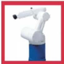
نصب روی کف
