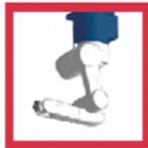
نصب روی سقف
