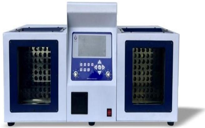
هدف از ندوین **تست ویسکوزیته**، تعیین روشی برای اندازه‌گیری ویسکوزیته یا گرانزوی کینماتیک فرآورده‌های نفتی مایع، تیره و شفاف است. ویسکوزیته‌ی یک مایع با اندازه‌گیری زمان جریان یافتن حجمی از آن، بر اثر نیروی جاذبه در یک ویسکومتر کالیبره شده تعیین می‌شود. ویسکوزیته‌ی به بیان دیگر ویسکازیته دینامیک از حاصل ضرب ویسکوزیته کینماتیک در حجمی مایع به دست می‌آید.
