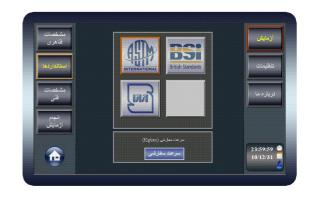
بر اساس ابعاد و شکل نمونه وارد شده به سیستم ، سرعت اعمال نیرو به نمونه طبق استاندارد انتخابی محاسبه و به دستگاه اعمال می گردد .
