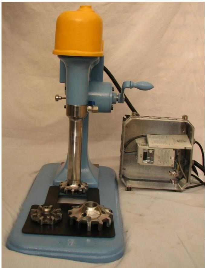
سلول فلوتاسیون آزمایشگاهی شرکت کانی کاران طرح D-12 شرکت دنور آمریکا می‌باشد. این سلول ترکیب مدل D-1 و D-2 این شرکت می‌باشد. مدل D-1 برای انجام آزمایش‌های فلوتاسیون تا وزن یک کیلوگرم و D-2 برای دو کیلوگرم نمونه طراحی شده است. سلول D-12 با قابلیت تعویض ایمپلر و استاتور قابل استفاده به عنوان هر دو سلول می‌باشد. بنابراین برای آزمایش‌های رافر و اسکونجر می‌توان از پره و استاتور بزرگ و برای اهداف شستشو از مکانیزم کوچک استفاده کرد.
