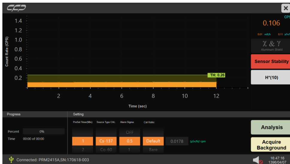
شکل ۳۰. ناپایداری سنسور بر اثر ضربه.
