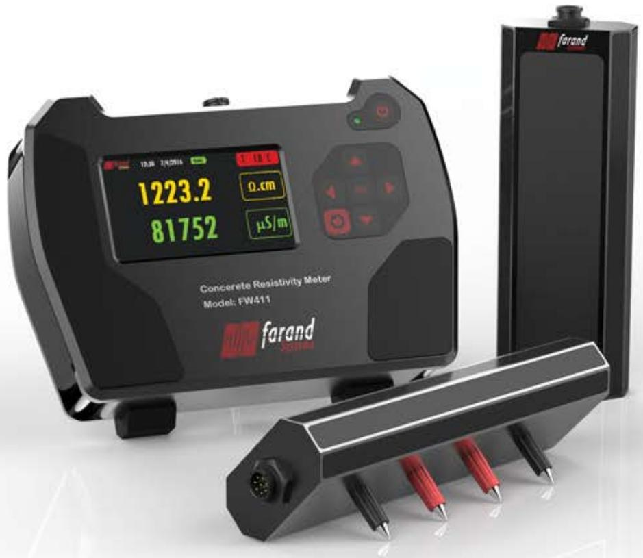
اندازه گیری مقاومت الکتریکی سطحی بتن یکی از روش های غیر مخرب بسیار کارآمد و ارزان برای ارزیابی خوردگی و نیز نفوذ یون کلراید در بتن است
