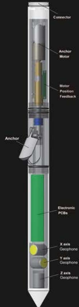
برای اتصال بهتر پروب به دیواره‌ی گمانه از یک اهرم الکترومکانیکی استفاده شده است. این اهرم که به عنوان بخشی از پروب در طراحی آن منظور شده است، با دریافت فرمان صادر شده از ایستگاه زمینی باز شده و اتصال مناسب را به جداره ایجاد می‌کند.
