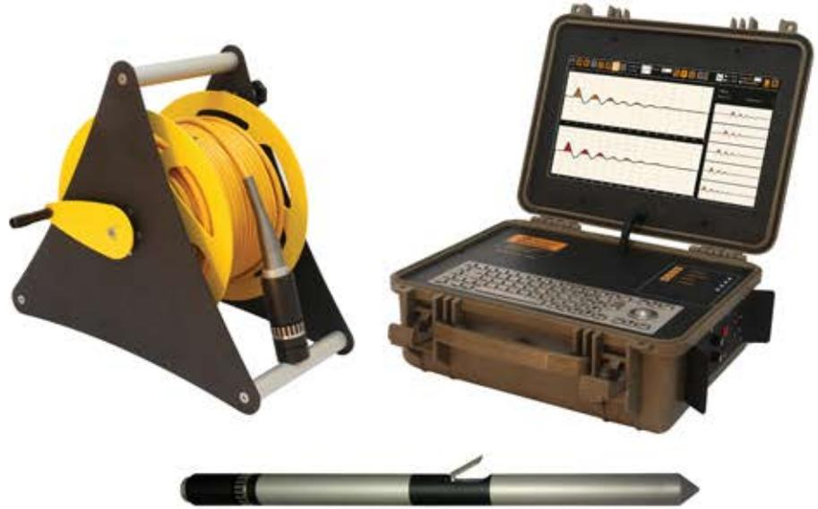
آزمونگر FD301 دستگاهی برای انجام آزمون لرزهنگاری درون گمانه است. این آزمونگر که تمامی شرایط عنوان شده در استاندارد ASTM-D7400 را برآورده می‌سازد، از یک پروب، یک ایستگاه زمینی و یک وینچ تشکیل شده است. آزمونگر FD301 در آرایشی یکپارچه و بهینه، ویژه‌ی انجام آزمون لرزهنگاری درون گمانه طراحی و ساخته شده است و این موضوع سبب سهولت بسیار در استقرار و استفاده از آن می‌گردد.
