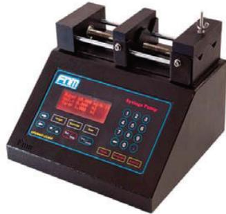
این سیستم در تمامی مواردی که نیاز به تزریق کم و کنترل شده محلول می‌باشد، کاربرد دارد.
