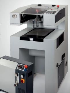
دستگاه جت پلاسمای سرد سیستمی کارآمد برای تولید پلاسمای سرد اتمسفری در هوا است که قابلیت پردازش سطوح فلزی و غیرفلزی در ابعاد صنعتی را دارد. امکان پردازش سطوح پیچیده، تنظیم قدرت پردازش بر اساس کاربرد از ویژگیهای این سیستم برای حصول نتایج چسبندگی مناسب در کاربردهای مختلف است.
