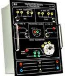
بر روی این مازول یک عدد ترانسمیتر صنعتی مخصوص کالیبراسیون حسگرهای دما قرار داده شده است که امکان اتصال به کامپیوتر و موبایل را برای تنظیم عملیات کالیبراسیون دارد.
