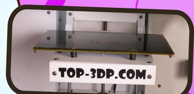
همان طور که در مطالب قبل به نحوه ی عملکرد پرینتر های **FDM** اشاره کردیم این پرینتر ها مواد مصرفی را با استفاده از نازل ذوب کرده (بسته به نوع ماده مصرفی دمای مناسب با آن نیاز است) و سپس براساس طرح سه بعدی بر روی پلتفرم قرار می دهند.
