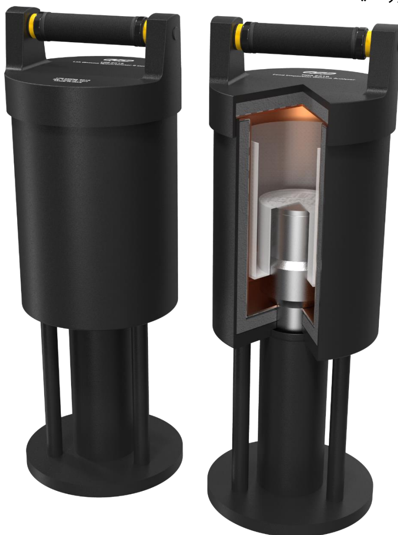
شکل ۱ تصویر کامل و برش خورده دستگاه به همراه ظرف مارینلی
