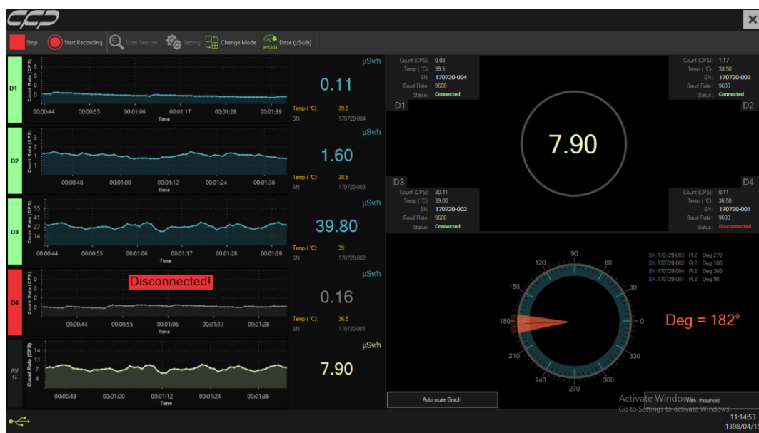
شکل ۳۳ قطع بودن یکی از سنسورها.
