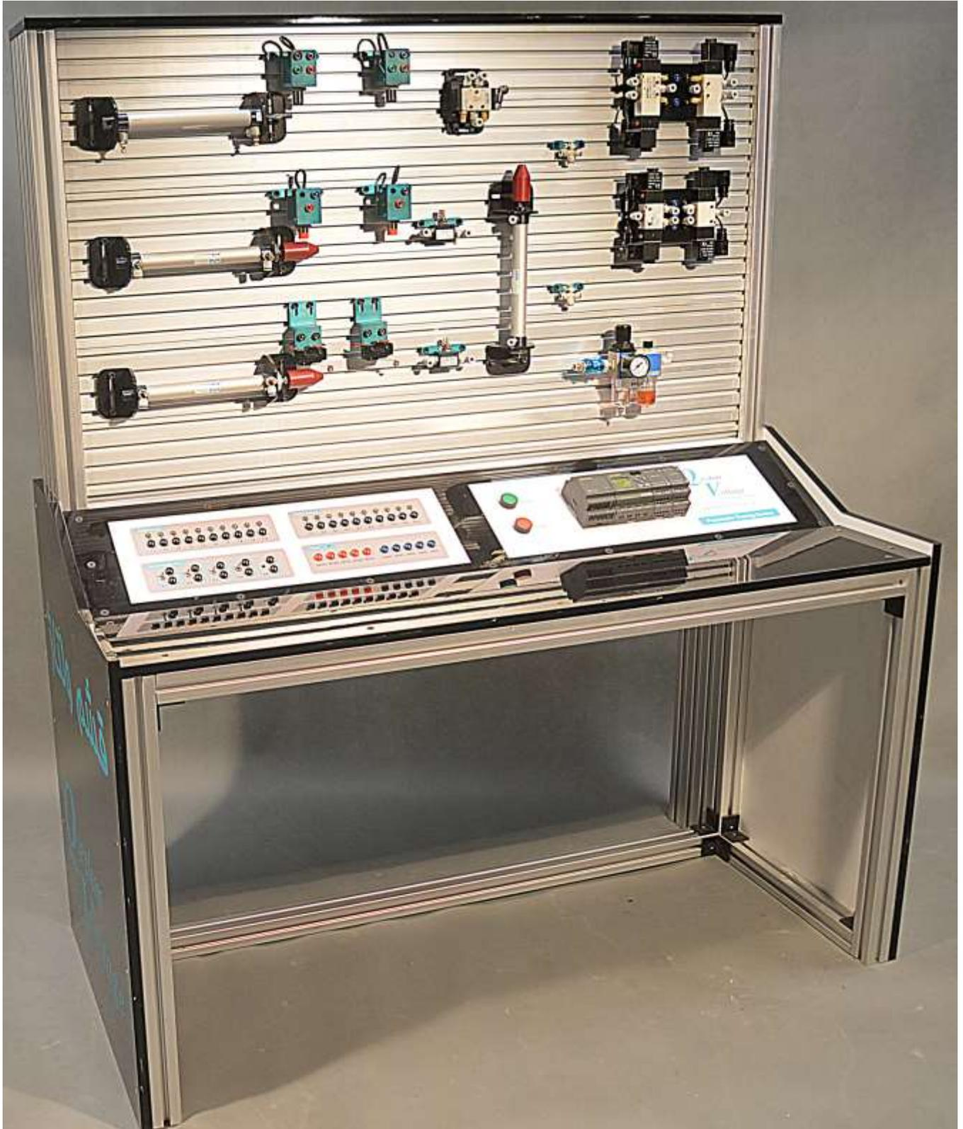
مجموعه فوق ترکیبی از بخش مکانیک و الکترونیک می باشد که هر دو بخش مستلزم مراقبت و نگهداری می باشد. در بخش مکانیک می بایست کلیه تجهیزات ( نظیر سیلندر ها ، پروفیل ها ، ساپورتها و .... ) هر ماه از لحاظ عملکرد ، خوردگی ، زنگ زدگی و .... بررسی شوند. شلنگهای پنوماتیک ، فلو کنترلرها می بایست از لحاظ نشتی هوا بررسی شوند. در بخش الکترونیک نیز می بایست سنسورها ، شیربرقی ها از لحاظ اتصال به فانکشن سیمولاتور ( قطعی سیم و خرابی فیصها ) بررسی شوند.
