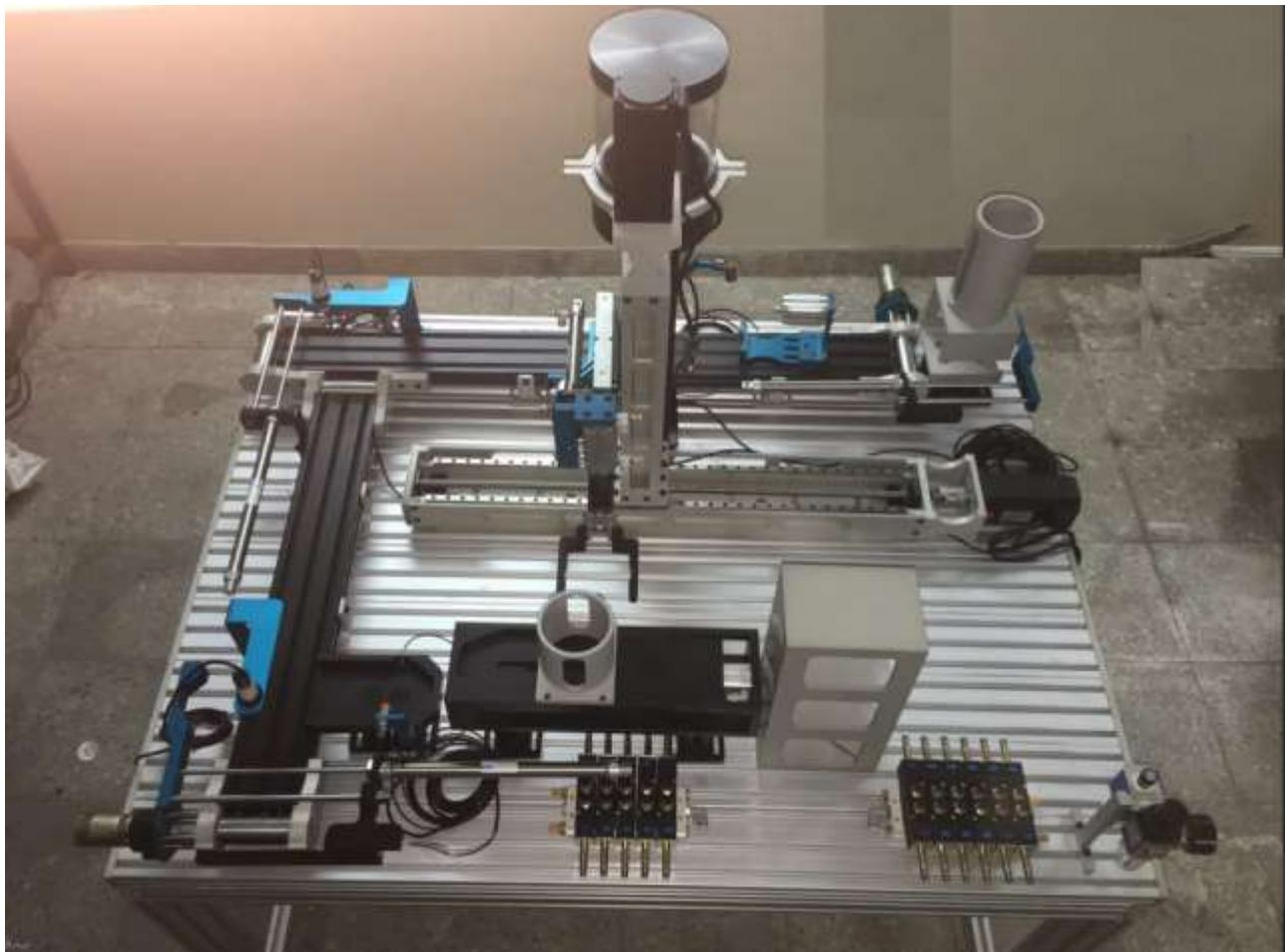
مجموعه فوق ترکیبی از بخش مکانیک و الکترونیک می باشد که هر دو بخش مستلزم مراقبت و نگهداری می باشد . در بخش مکانیک می بايست کلیه تجهیزات ( نظیر سیلندرها ، پروفیل ها ، ساپورتها و .... ) هر ماه از لحاظ عملکرد ، خوردگی ، زنگ زدگی و .... بررسی شوند. شلنگهای پنوماتیک ، فلو کنترلرها می بايست از لحاظ نشتی هوا بررسی شوند. در بخش الکترونیک نیز می بايست سنسورها ، موتورها، شیربرقی ها از لحاظ اتصال به فانکشن سیمولاتور ( قطعی سیم و خرابی فیشها ) بررسی شوند.
