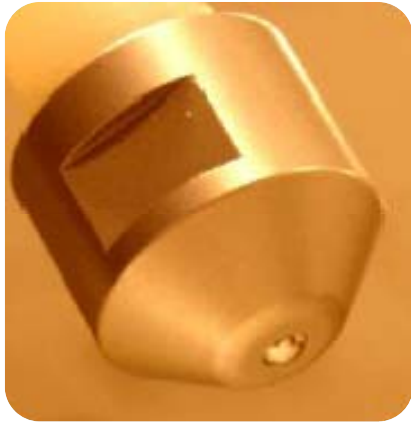
شکل ۱- تصویر محل قرارگیری گلوله و نمونه سایش، مسیر سایش، جهت چرخش دیسک و نیز نگهدارنده‌ی گلوله.
