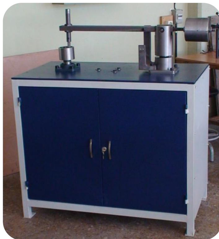
شکل ۳- دستگاه آزمون سایش در دمای محیط.
