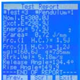
گزارش کامل تست با مشخصات دینامیکی پاندول بصورت عملی
