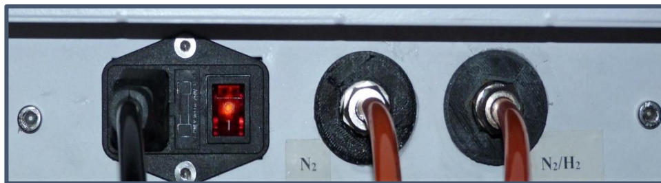
شکل ۵- ورودی برق و کپسول ها
