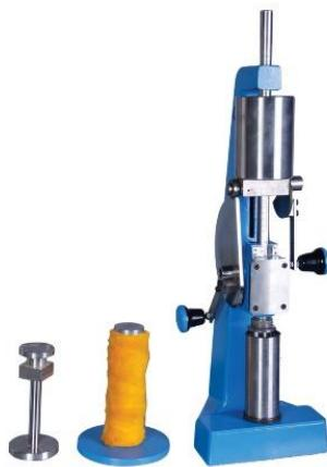
این دستگاه برای آماده‌سازی نمونه‌های ماسه ریخته‌گری و به دنبال آن آزمایش نمونه براساس روش‌های مشخص شده در این دستورالعمل بکار می‌رود. ماسه ریخته‌گری فقط از طریق آماده‌سازی و کوبیدن هماهنگ، خصوصیات فیزیکی و مکانیکی دقیق را می‌گیرد. برای اینکه بتوان این خصوصیات را اندازه‌گیری کرد نمونه‌ای از مخلوط ماسه برای آزمایش برداشته می‌شود و با کوبیدن توسط کوبه به شکل نمونه مناسب برای انجام آزمایش در می‌آید.
