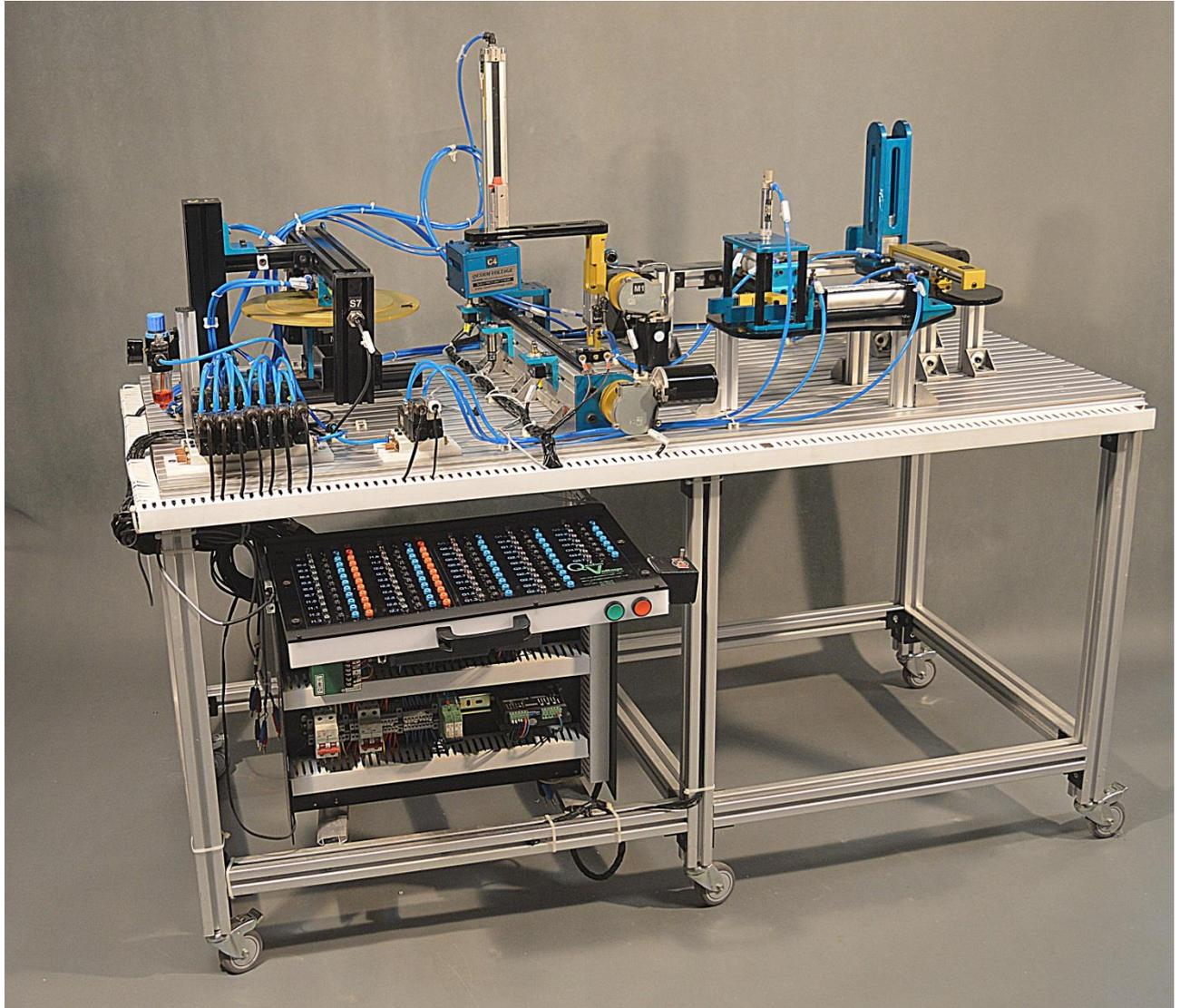
مجموعه فوق ترکیبی از بخش مکانیک و الکترونیک می باشد که هر دو بخش مستلزم مراقبت و نگهداری می باشد. در بخش مکانیک می بایست کلیه تجهیزات ( نظیر سیلندرها، پروفیل ها، ساپورتها و .... ) هر ماه از لحاظ عملکرد، خوردگی، زنگ زدگی و .... بررسی شوند. شلنگهای پنوماتیک، فلو کنترلرها می بایست از لحاظ نشتی هوا بررسی شوند. در بخش الکترونیک نیز می بایست سنسورها، موتورها، شیربرقی ها از لحاظ اتصال به فانکشن سیمولاتور ( قطعی سیم و خرابی فیشها ) بررسی شوند.
