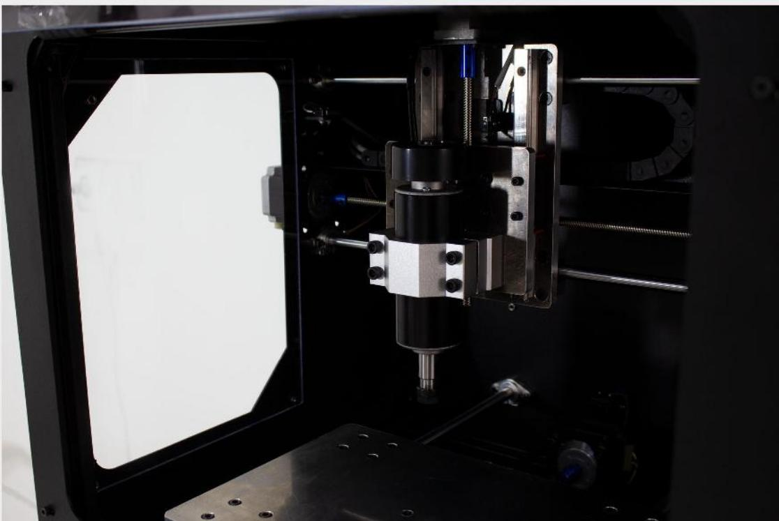
سی زان میکسا برای محیط های آموزشی و کارگاههای کوچک طراحی شده است. از آنجا که وجود صدای کم و آرامش برای محیط های یاد شده ضروری است، محفظه بسته سی زان میکسا باعث می شود تا صدای کمتری در محیط منتشر شود. همچنین بدلیل وجود مکانیزم تمیزکننده (بعنوان ابزار جانبی)، براده ها و آلودگی ناشی از ماشین کاری به محل استفاده دستگاه راه پیدا نمی کند.
