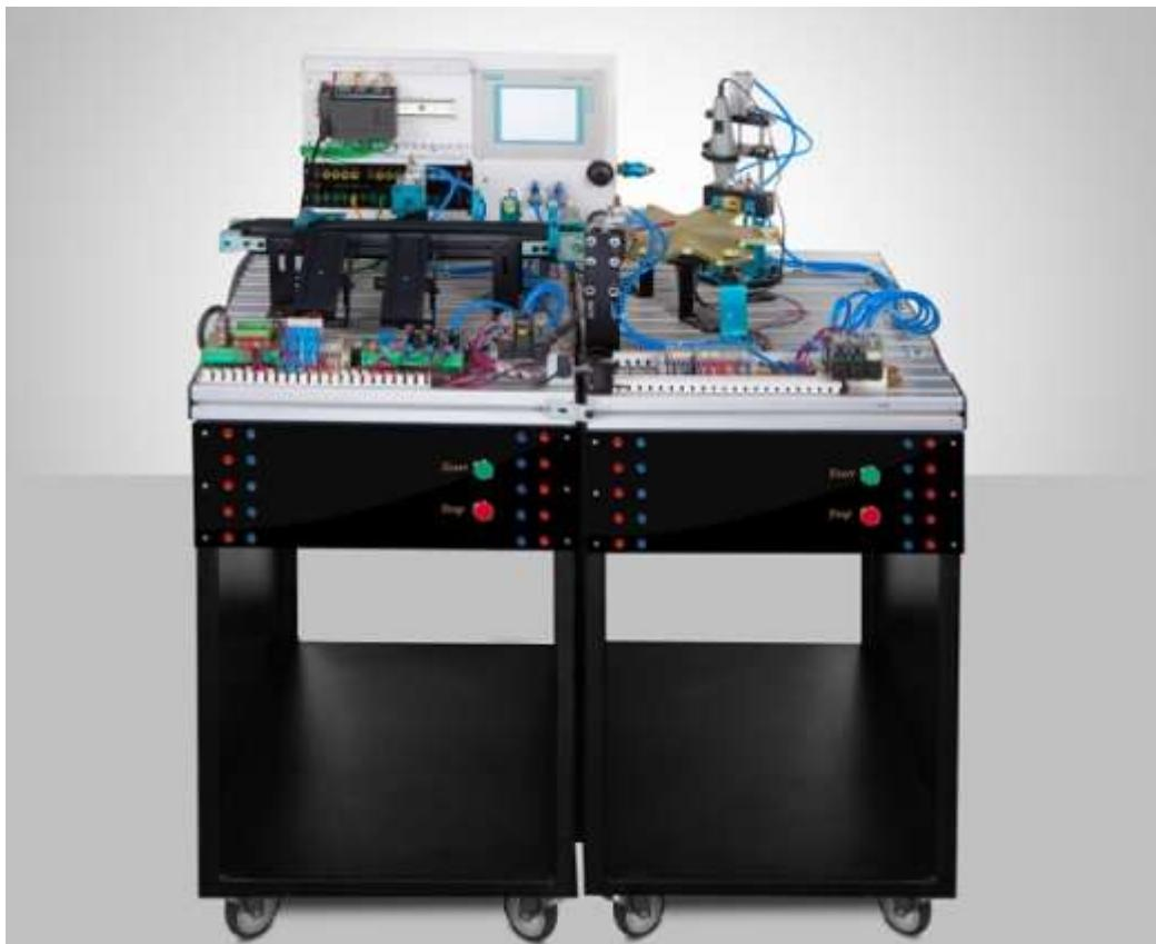
مجموعه فوق ترکیبی از بخش مکانیک و الکترونیک می باشد که هر دو بخش مستلزم مراقبت و نگهداری می باشد . در بخش مکانیک می بايست کلیه تجهیزات ( نظیر سیلندرها ، پروفیل ها ، ساپورتها و .... ) هر ماه از لحاظ عملکرد ، خوردگی ، زنگ زدگی و ... بررسی شوند. شلنگهای پنوماتیک ، فلو کنترلرها می بايست از لحاظ نشتی هوا بررسی شوند. در بخش الکترونیک نیز می بايست سنسورها ، موتورها، شیربرقی ها از لحاظ اتصال به فانکشن سیمولاتور ( قطعی سیم و خرابی فیشها ) بررسی شوند.
