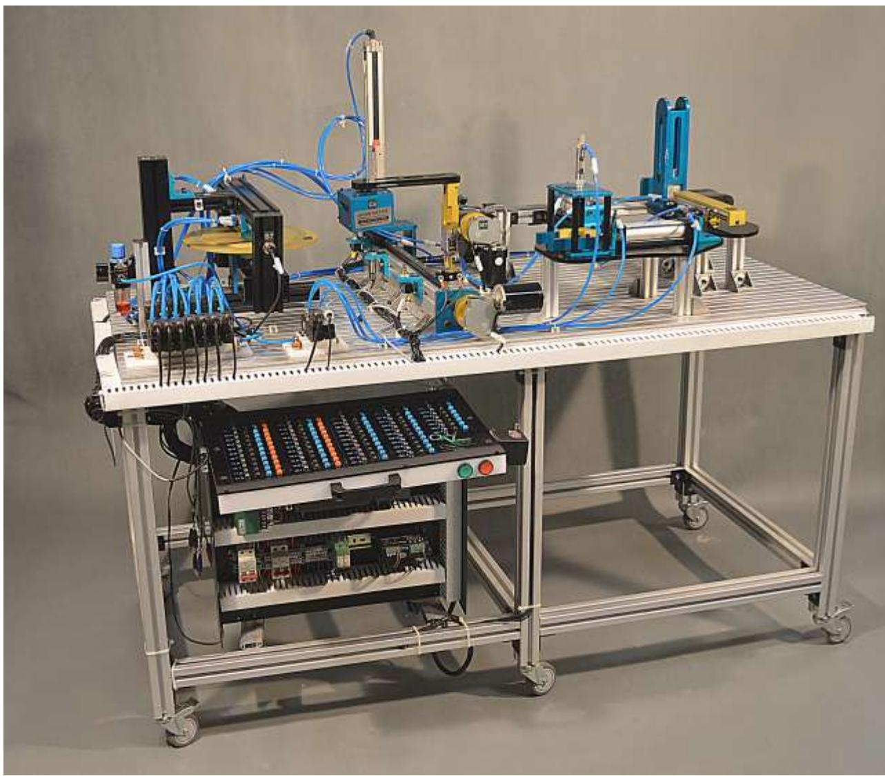
مجموعه فوق ترکیبی از بخش مکانیک و الکترونیک می باشد که هر دو بخش مستلزم مراقبت و نگهداری می باشد . در بخش مکانیک می بايست کلیه تجهیزات ( نظیر سیلندرها ، پروفیل ها ، ساپورتها و .... ) هر ماه از لحظه عملکرد ، خوردگی ، زنگ زدگی و .... بررسی شوند. شلنگهای پنوماتیک ، فلو کنترلرها می بايست از لحظه نشتی هوا بررسی شوند. در بخش الکترونیک نیز می بايست سنسورها ، موتورها، شیربرقی ها از لحظه اتصال به فانکشن سیمولاتور ( قطعی سیم و خرابی فیشها ) بررسی شوند.
