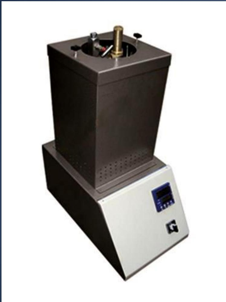
روش‌های مختلفی برای آزمایش کنترل سلامت سیمان وجوددارد یکی از این روش‌ها استفاده از دستگاه اتوکلاو می‌باشد.
