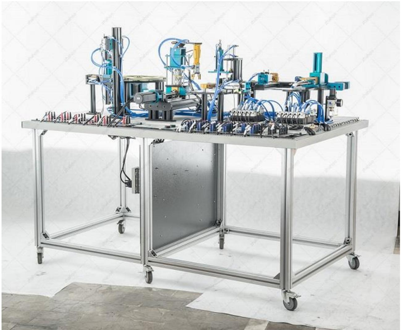
مجموعه فوق ترکیبی از بخش مکانیک و الکترونیک می باشد که هر دو بخش مستلزم مراقبت و نگهداری می باشد . در بخش مکانیک می بایست کلیه تجهیزات ( نظیر سیلندرها ، پروفیل ها ، ساپورتها و .... ) هر ماه از لحاظ عملکرد ، خوردگی ، زنگ زدگی و .... بررسی شوند. شلنگهای پنوماتیک ، فلو کنترلرها می بایست از لحاظ نشتی هوا بررسی شوند. در بخش الکترونیک نیز می بایست سنسورها ، موتورها، شیربرقی ها از لحاظ اتصال به فانکشن سیمولاتور ( قطعی سیم و خرابی فیשהا ) بررسی شوند.
