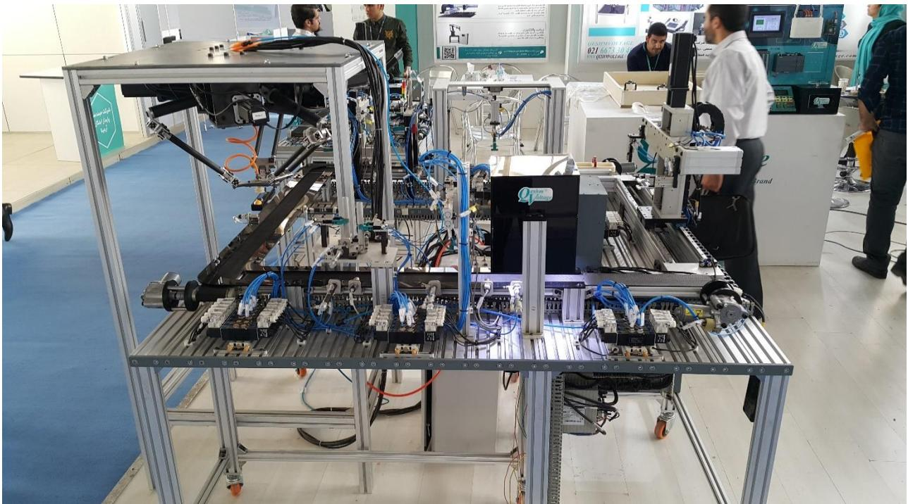
مجموعه فوق ترکیبی از بخش مکانیک و الکترونیک می باشد که هر دو بخش مستلزم مراقبت و نگهداری می باشد . در بخش مکانیک می باشد کلیه تجهیزات ( نظیر سیلندرها ، پروفیل ها ، ساپورتها و .... ) هر ماه از لحاظ عملکرد ، خوردگی ، زنگ زدگی و .... بررسی شوند. شلنگهای پنوماتیک ، فلو کنترلرها می باشد از لحاظ نشتی هوا بررسی شوند. در بخش الکترونیک نیز می باشد سنسورها ، موتورها، شیربرقی ها از لحاظ اتصال به فانکشن سیمولاتور ( قطعی سیم و خرابی فیشهای ) بررسی شوند.
