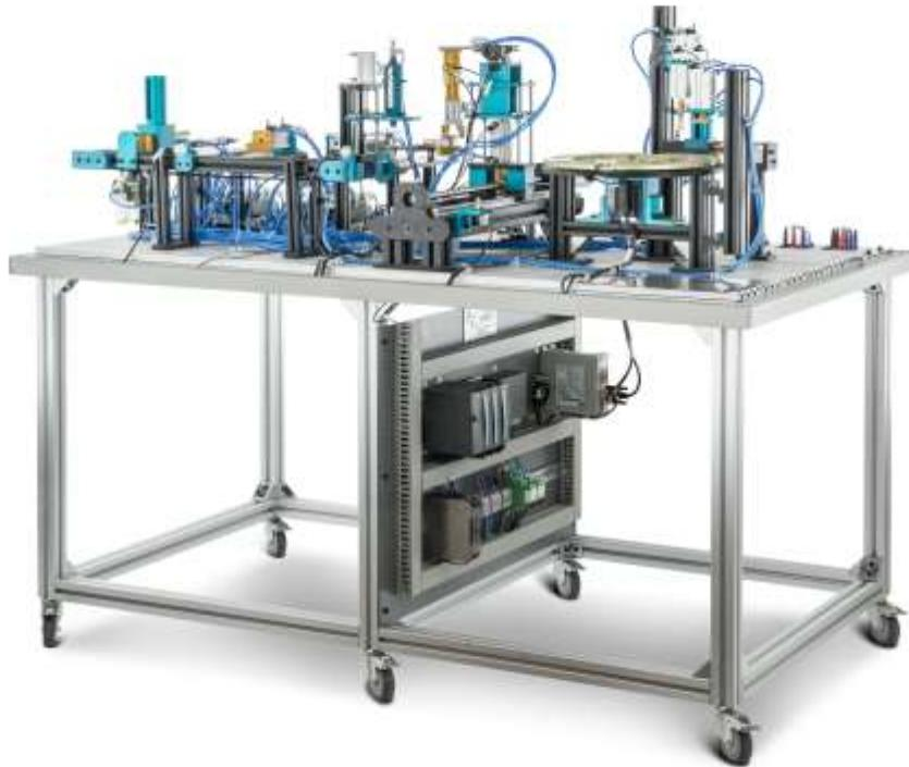
مجموعه فوق ترکیبی از بخش مکانیک و الکترونیک می باشد که هر دو بخش مستلزم مراقبت و نگهداری می باشد . در بخش مکانیک می بايست کلیه تجهیزات ( نظیر سیلندرها ، پروفیل ها ، ساپورتها و .... ) هر ماه از لحظه عملکرد ، خوردگی ، زنگ زدگی و ... بررسی شوند. شلنگهای پنوماتیک ، فلو کنترلرها می بايست از لحظه نشتی هوا بررسی شوند. در بخش الکترونیک نیز می بايست سنسورها ، موتورها، شیربرقی ها از لحظه اتصال به فانکشن سیمولاטור ( قطعی سیم و خرابی فیشهای ) بررسی شوند.
