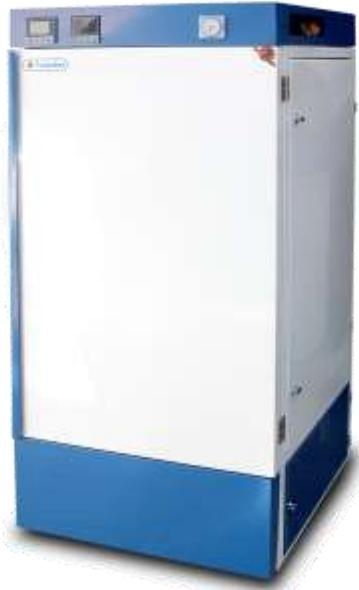
بدنه : بدنه خارجی از ورق روغنی با رنگ الکتروستاتیک و بدنه داخلی از جنس استیل ۳۰۴
