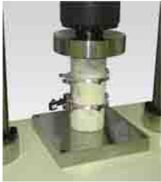
دستگاه STD-600B به همراه فک های فشاری و اکستنسومتر جهت اندازه گیری کرنش طولی
