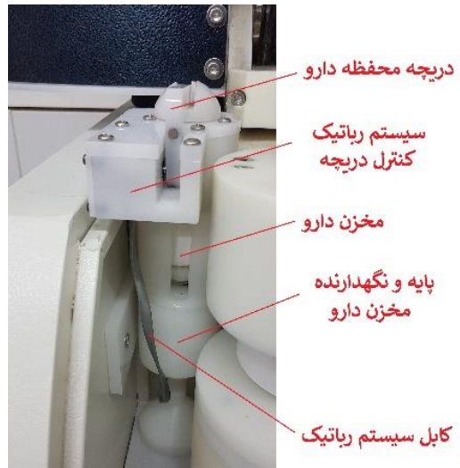
تصویر 10 مخزن دارو و اجزای مربوط به آن
