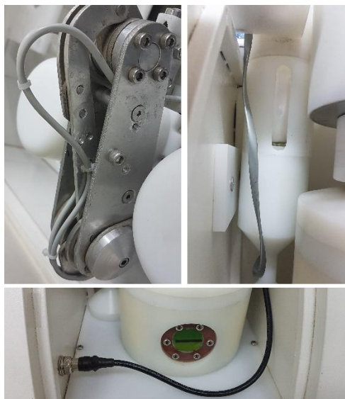
تصویر 7 کابل های سیستم رباتیک
