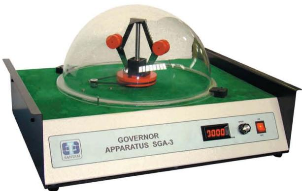
جهت بررسی منحنی مشخصه گاورنر، اختلاف و مقایسه بین منحنیهای واقعی و تئوری گاورنرها، ارتباط وزنه Sleeve با دیگر مشخصه های گاورنر، ارتباط بین نسبت بازوی گاورنر و ضریب سختی فنر و میزان فشردگی و بررسی پایداری و حساسیت گاورنر دستگاه گاورنر طراحی شده است.
