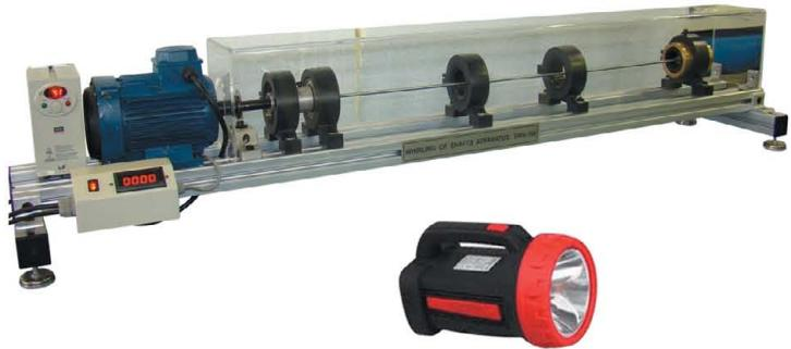
جهت بررسی و تحقیق ارتعاش شفت دستگاه و ثبت مدل‌های ارتعاشی اول و دوم با شرایط مختلف و (ممان ایزنسی و طول‌های مختلف و شرایط تکیه گاهی متفاوت) به کمک تغییر دور موتور دستگاه استراابوسکوپ دستگاه دور بحرانی شفت‌ها طراحی شده است.
