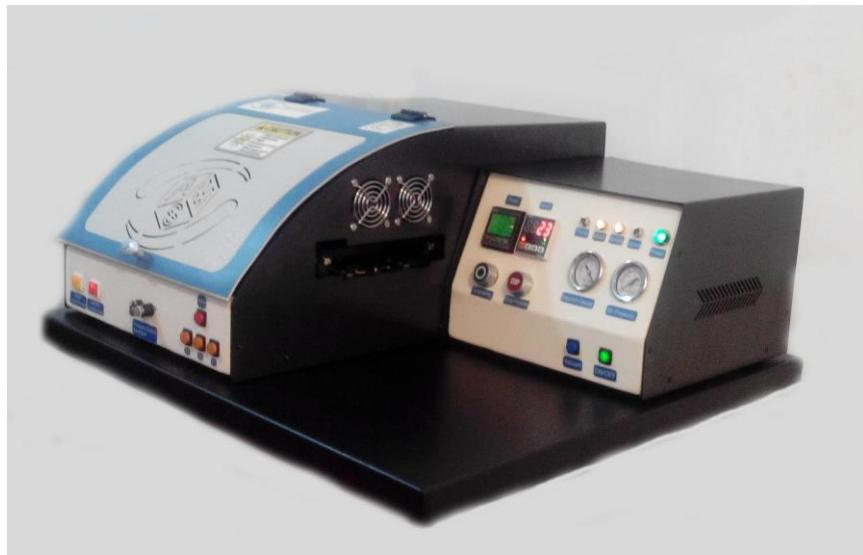
دستگاه لیتوگرافی رومیزی یکی از دستگاههایی است که در فرایند لیتوگرافی بکار می‌رود. از آنجا که فرایند لیتوگرافی اولین مرحله ساخت ادوات نیمه هادی است، لذا این تجهیزات نقش مهمی را ایفا می‌کنند. شایان ذکر است که در نمونه‌های جدید برای افزایش دقیقیت دستگاه از طراحی بهتری استفاده شده است.
