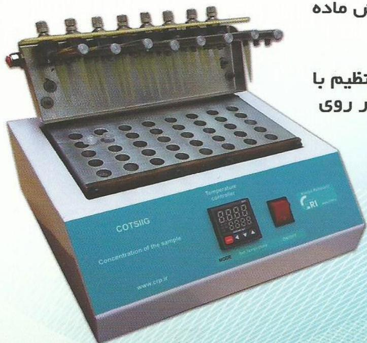
از این دستگاه برای جدا سازی حلال با نقطه جوش بالاتر از نقطه جوش ماده موثر (ماده مورد اندازه گیری) استفاده می شود.
