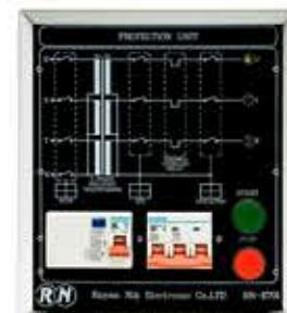
این ماژول متشکل از ترانسفورماتور ایزوله کننده سه فاز، کلید محافظ جان، بی متال و کنتاکتور است که استفاده از آن در ورودی سیستم باعث کاهش خطرهای ناشی از برق گرفتگی می شود، لذا توصیه می گردد این ماژول نباید به همراه سیستم خریداری شود.
