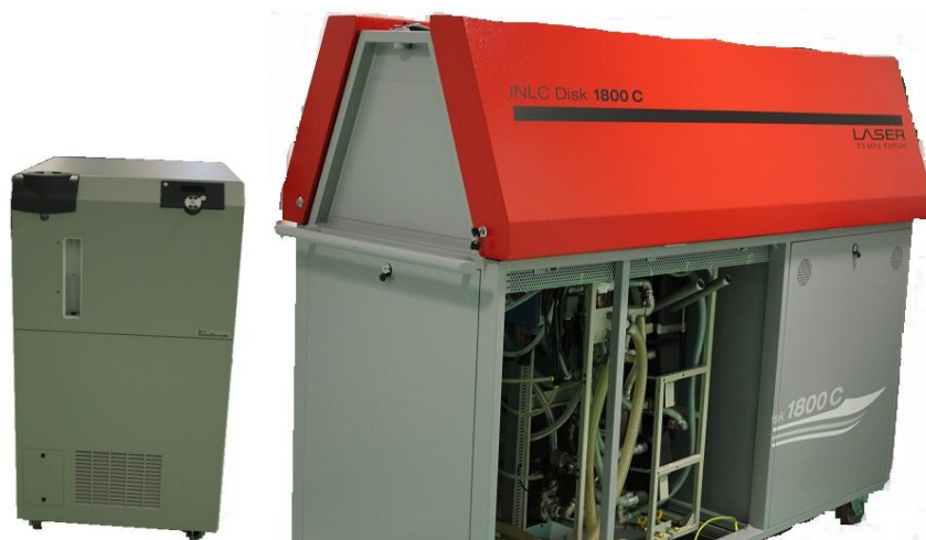
شکل ب-۱. تصویر سامانه خنک‌ساز داخلی دستگاه و چیلر
