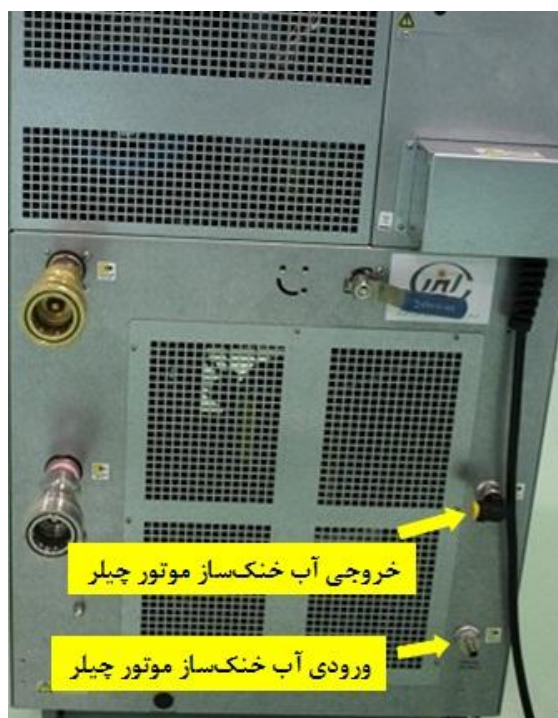
شکل ۵. محل خنک‌کننده (موتور) چیلر
