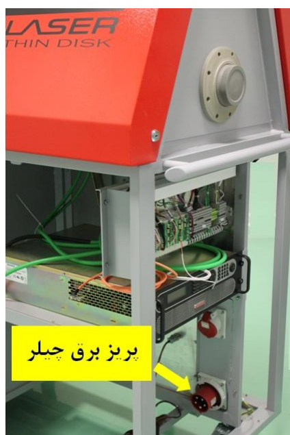
شکل ب-۲. محل تامین برق چیلر در دستگاه
