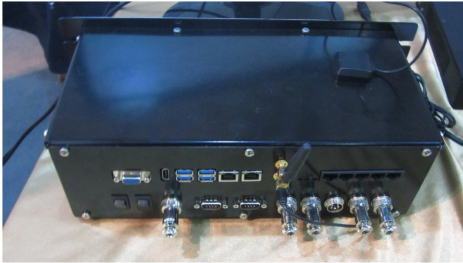
شکل ۳- RTU طراحی شده برای سامانه هشدار سریع زلزله
