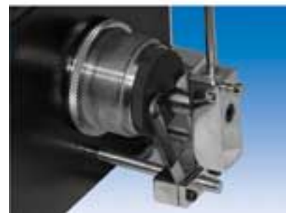
سندان قابل تنظیم و محافظ مکانیکی پاندول
